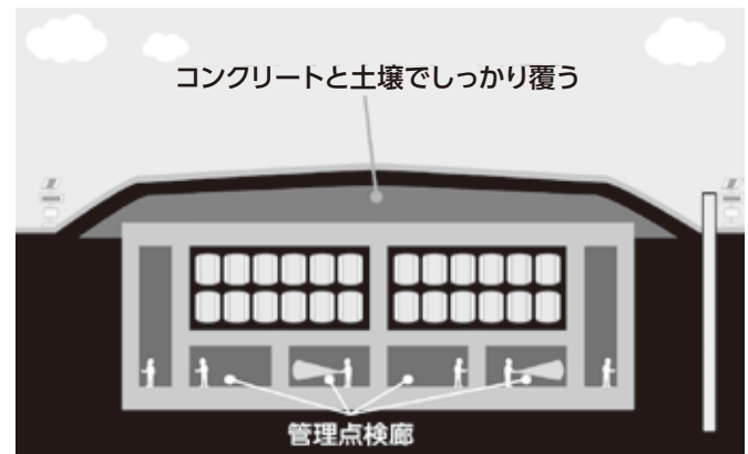
◎コンクリート2重構造の堅固な施設としています。
