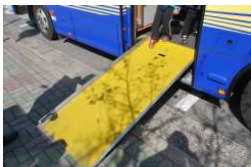
車いす用スロープ。歩道の高さに関わらず設置できる。運転手の介添えは必要。
